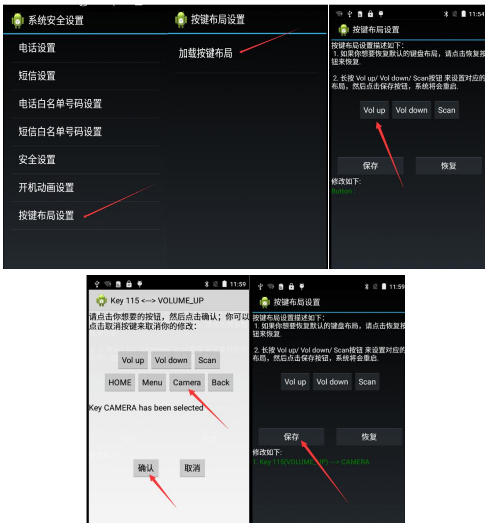
图 5.5-1 按键布局设置完成相关指示图
